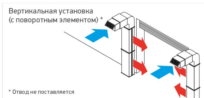
Рис. 25. Вертикальная установка воздушной завесы при малой площади проема
